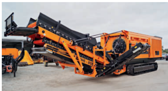
Шредер Doppstadt DW 3080 K3 в сочетании с новым звездочным грохотом DHS 812 сразу сортирует измельченный материал на три фракции
