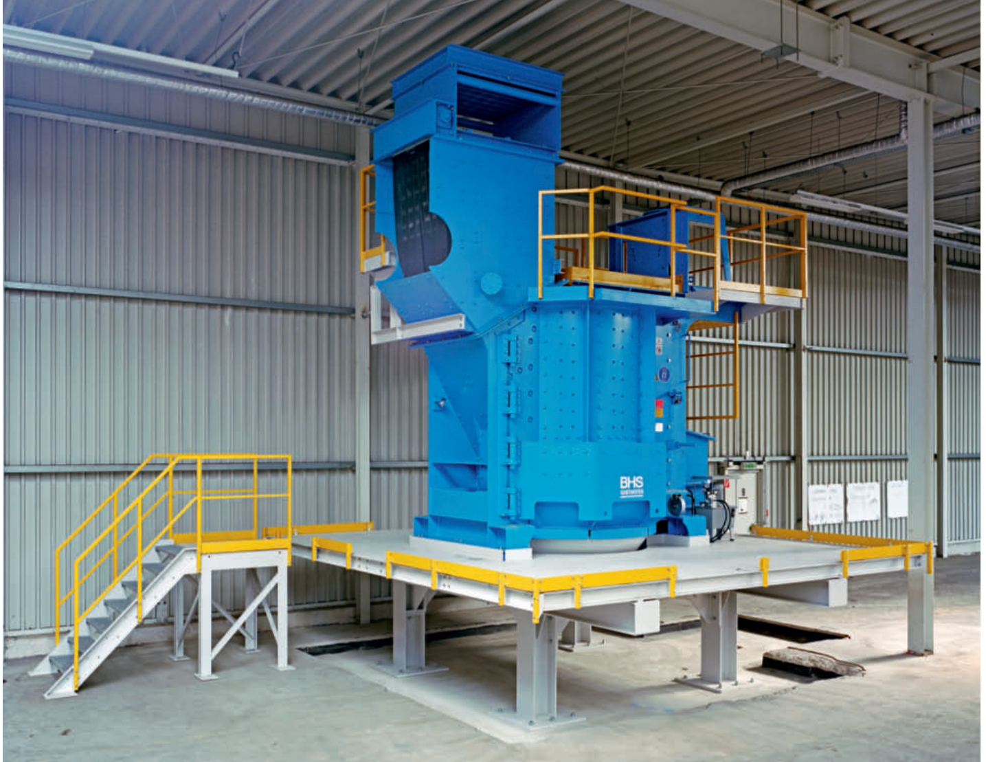
Роторный измельчитель типа RS фирмы BHS в процессе постройки перерабатывающей установки
