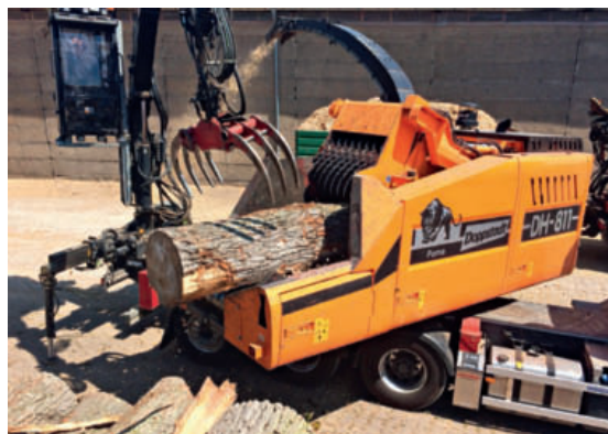
Измельчитель с точной длиной резки DH 811 L в качестве поворотного варианта для использования и транспортировки на шасси грузового автомобиля
