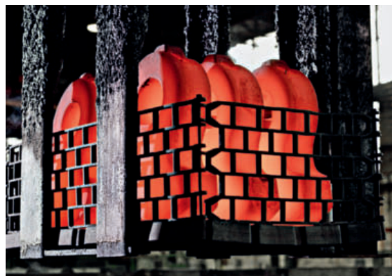
Все отливки проходят термообработку с помощью компьютерного управления
