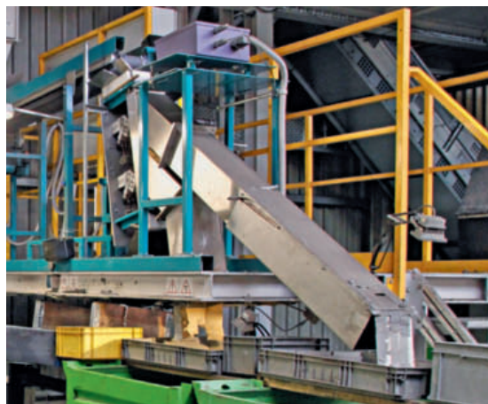
◀ Planitec color sorter for precious metal sorting Planitec Farbsortierer für die Edelmetallsortierung
