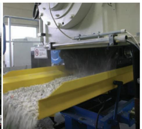
**Bewährtes Verfahren.** Für die Aufbereitung von Spuckstoffzöpfen hat ANDRITZ MeWa ein zweistufiges Verfahren entwickelt: Die Universal Rotorschere UC wird für die Vorzerkleinerung des zähen Materials eingesetzt. Die Nachzerkleinerung übernimmt der Universal Granulator UG. Durch den Einsatz eines austauschbaren Siebes kann entscheidend Einfluss auf den Durchsatz und das Ergebnis genommen werden.
