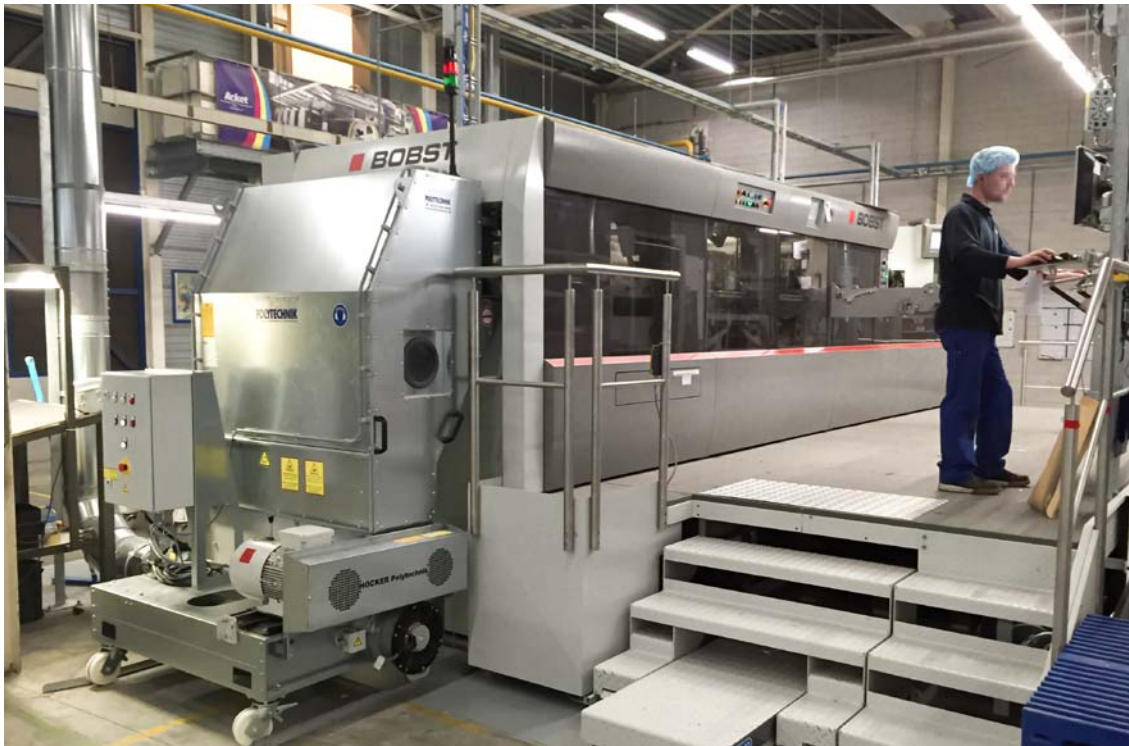
◀ PHSS shredder in combination with high-performance die cutter PHSS Shredder in Kombination mit einer Hochleistungsstanze
