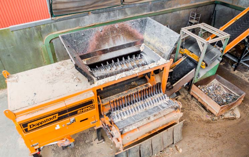
◀ The new DW 308 Rhino features the QuickChange system Der neue DW 308 Rhino verfügt über das Schnellwechselsystem
